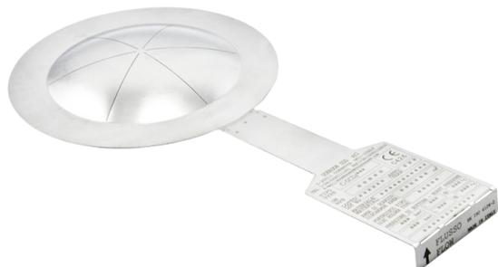
El disco de ruptura DonadonSDD tipo SCD obtenido con la tecnología NS Nanoscored es un disco con sección calibrada de tipo micro entallado con forma de pétalo caracterizado por la presencia de 4, 6 o más entallados radiales.
